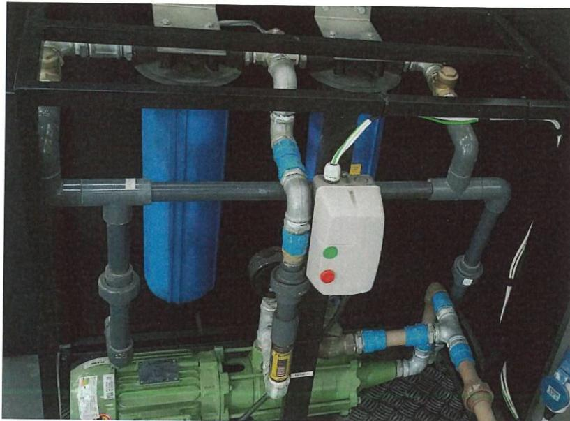
Desarrollado para atender la necesidad de utilizar impeders con retorno de flujo en su línea formadora de tubos, nuestro sistema permite alcanzar una presión de hasta 8Bar, y cuenta con un sistema de filtrado que proporciona eficiencia en la re-circulación del fluido de enfriamiento.
