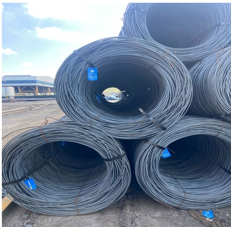
Foto #7: Muestra de la colocación de la etiqueta en varilla en rollo
