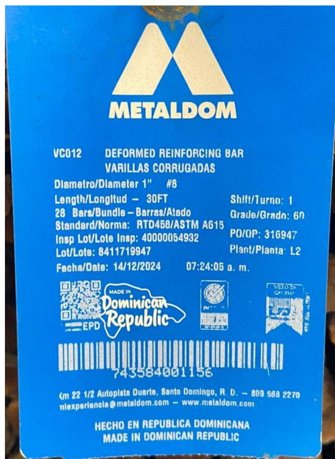
Foto #6: Muestra de la información requerida Para varilla recta.
