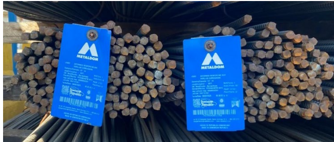
Fotos #6: Muestra de la colocación de la etiqueta en varilla recta.
