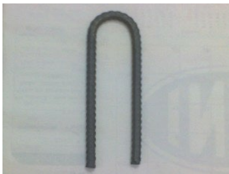
Foto 1 - Muestra de Prueba de Flexión
