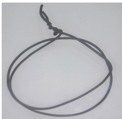
Foto #2 – Muestra de las argollas utilizadas para amarrar
