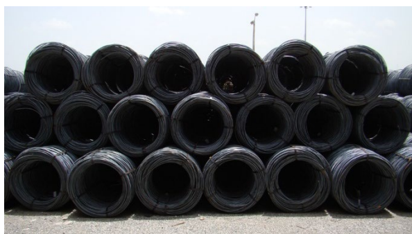
Foto #5 – Muestra de estiba de varilla en rollo
