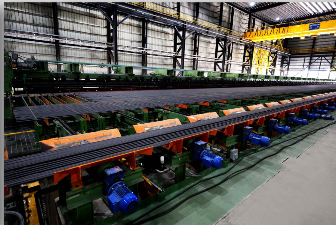
Cama de enfriamiento
